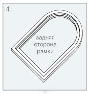
Сделайте разметку под отверстие по размеру ниши, в том месте, где планируется установка изделия.
