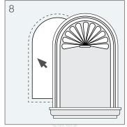
Соедините и зафиксируйте нишу с декоративным элементом (рамкой) между собой при помощи саморезов по кругу.
