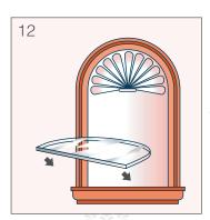
Закрепите изделие при помощи саморезов. Саморезы необходимо вкрутить, утопив их в само изделие, а затем зашпатлевать отверстия.
